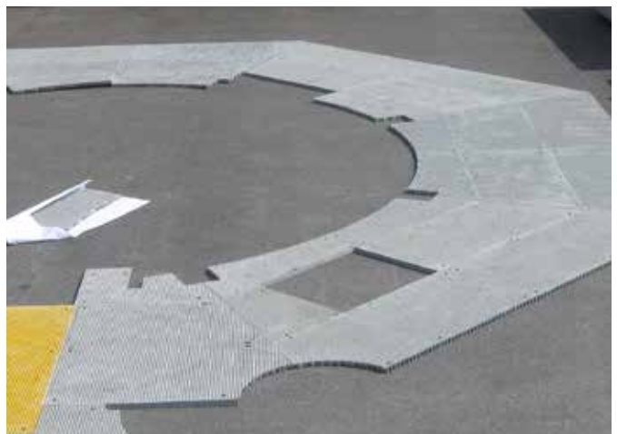
Unten rechts: Qualitätskontrolle von GFK- Gitterrosten
